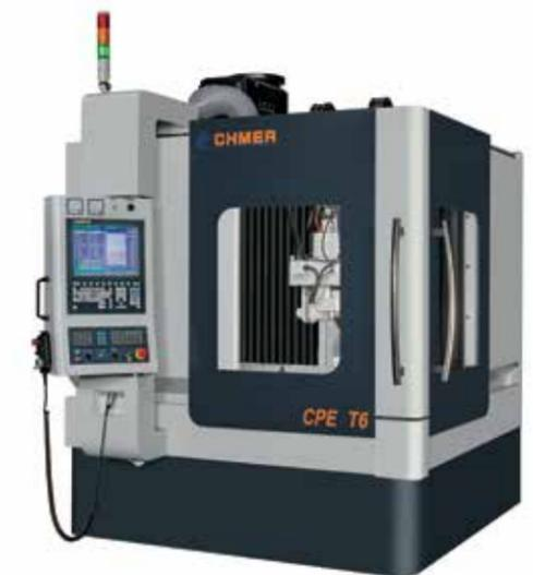
全國首創、由線性馬達驅動的「CPE T6-6軸PCD鋸片放電加工機」。
