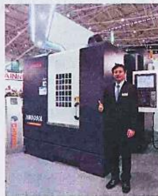
慶鴻機電HM6050L線馬驅動五軸高速加工機。
