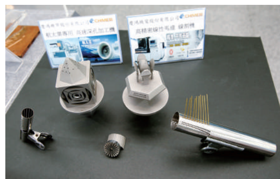
慶鴻線切割機、深孔加工機可搭載旋轉軸，滿足高複雜度、高難度、特殊材質之工件加工。(攝影：陳念舜)
