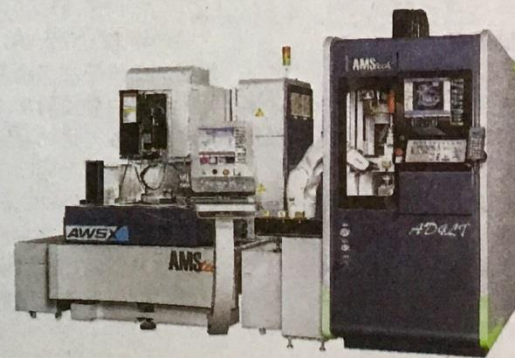
慶鴻機電AMS多用途深孔放電加工機與線切割機AW系列 慶鴻機電 / 提供
