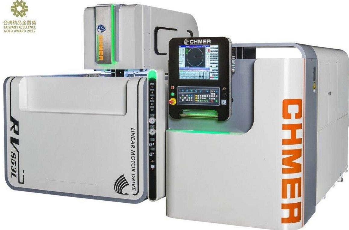
運用各項感知器回饋資訊於人機介面視窗，讓使用者快速掌握重要加工數據以提升加工效益；並可搭配遠端監控系統，使用者可藉手機等智慧型裝置做即時監控，大幅降低查訪機台時間成本。該機多項人性化智慧功能，協助操作者更便利加工，以創新與智能化為使用者帶來效益。
