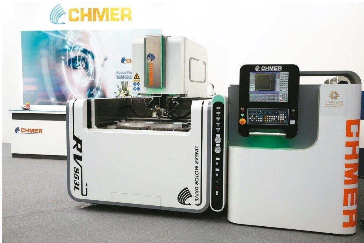
圖：慶鴻機電於 TIMTOS 展出獲台灣精品金質獎產品「RV853L 智能化線馬驅動線切割機」及多項智能化精密模具與零件加工設備。
