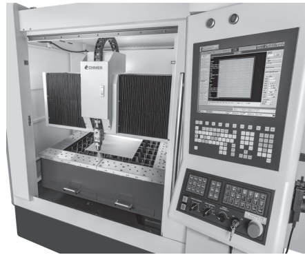
圖3 搭配慶鴻集團自行研發製造之控制器，重視雷射切割之蛙跳、飛切等智慧化功能。PL系列雷射切割軟硬體全權擁有，追加軟體新功能容易，積極提升加工便利性。
