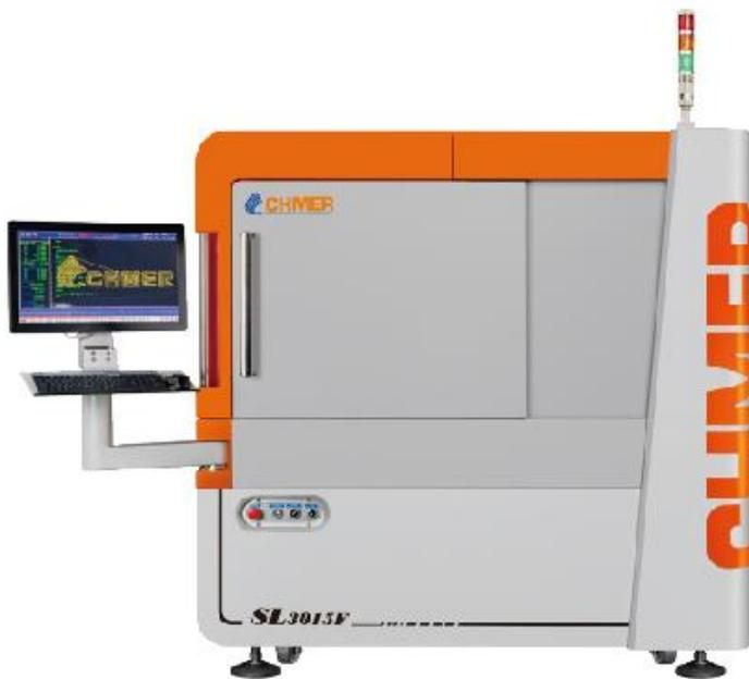
「SL3015F-高精密磁浮飛秒雷射切割機」獲第31屆「台灣精品獎」。SL3015F採用雷射短脈衝(fs)飛秒等級，對於半導體業、電子業、醫療業中常使用的陶瓷材料、PI膜、複合材料、薄金屬等加工可達成微米(um)級的高精密加工品質。
