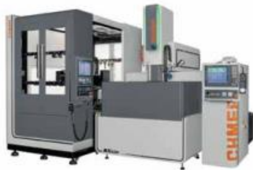
「DX655C-高速智能化離模放電加工機」主要應用於汽車業(扣件、通訊)、航太業(加工零組件)、精密3C塑膠模具、IT產業精密模具、半導體封裝產業之高精密模具與零件開發需求。
