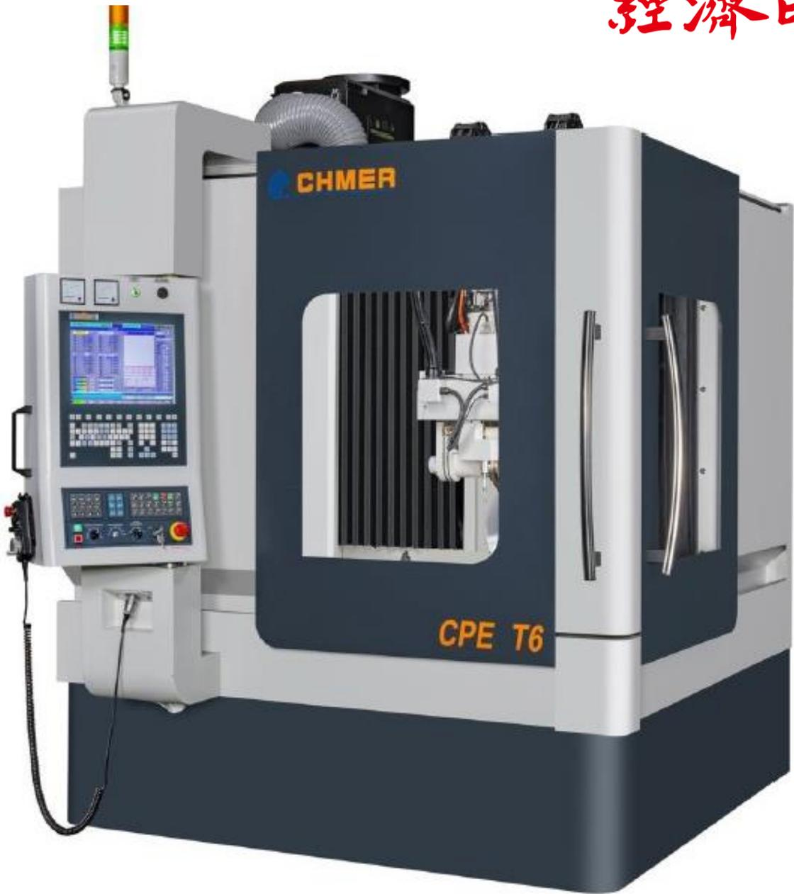
慶鴻展出全國首創、台灣第一台由線性馬達驅動的6軸PCD鋸片放電加工機CPE T6，以放電方式取代傳統砂輪研磨，針對超硬材質有更高的加工效率與表面品質，解決傳統研磨機高消耗之苦。慶鴻機電／提供
