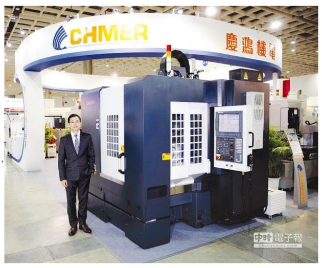
慶鴻機電總經理王陳鴻表示·CIMT展出「HM6050L線馬驅動五軸高速加工機」,滿足汽車、航太業鈦合金、鋁合金等複雜零件曲面高效率與高等級的 5 軸加工需求。圖 / 業者提供
