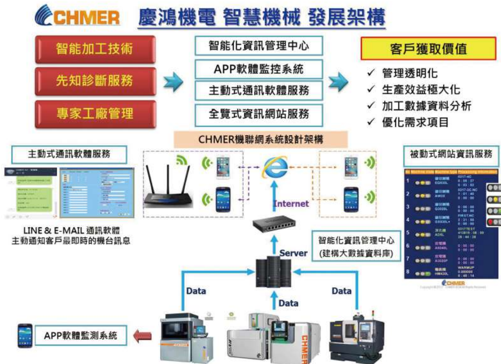
圖2 慶鴻機電智慧機械發展架構，期以多元方式提供全方位智慧服務，為客戶增值。
