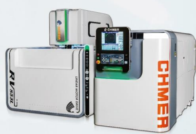
RV853L 智能化線性馬達驅動線切割機
